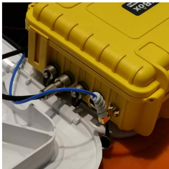
④ 连接915Mhz天线和RTK数据端口
