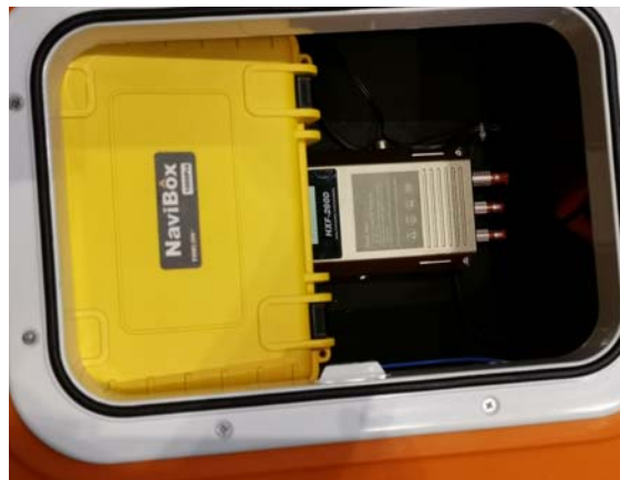
② 将测深仪放置在船艙合适位置
