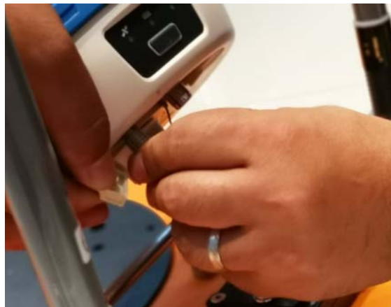
② 连接RTK小五芯数据线
