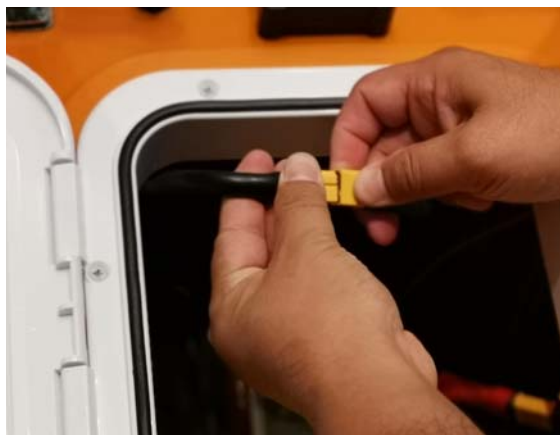
② 连接电池和电源线
