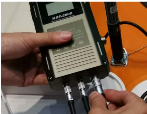
① 连接测深仪各端口
