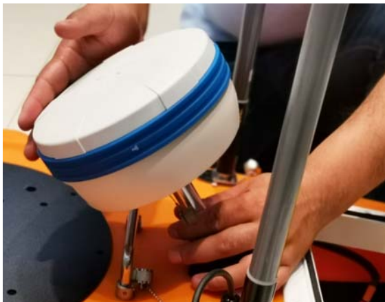
① 将RTK主机旋转安装在金属底座上
