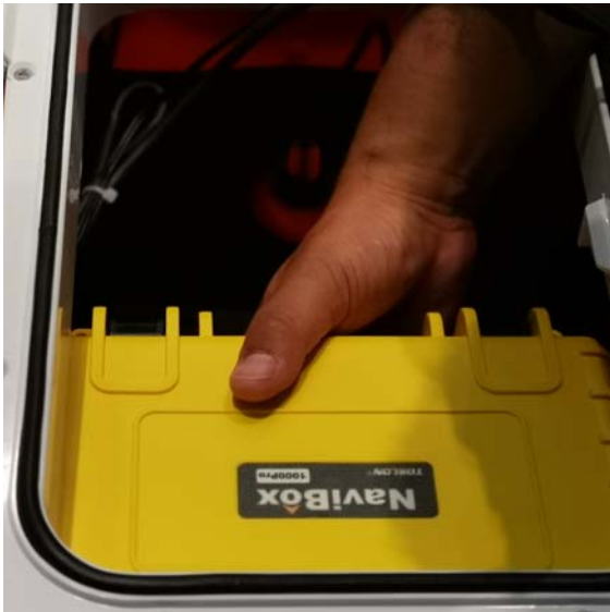
⑦ 连接完毕后，将NaviBox放置在船舱内（船艏合适位置）
